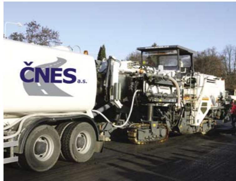
Recyklér za studena 2200CR, se vstřikovacími systémy pro vodu a emulzi.
