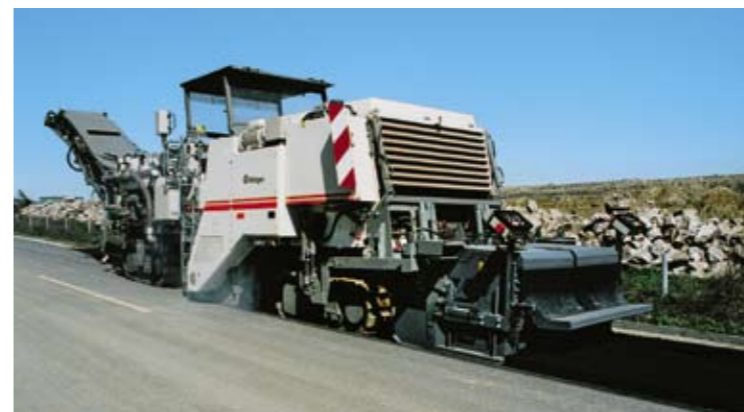
Recyklér za studena 2200CR vybavený vstřikovacím systémem pro vodu a vstřikovacím systémem pro asfaltovou emulzi, rozdělovacím šnekem a pokládací lištou.
