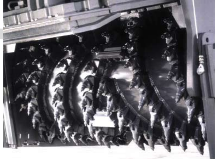
Frézovací a mísící rotor stroje 2200CR (se systémem rychlé výměny držáků nástrojů HT11 na fotografii) je možno vybavit různými noži s válcovým dřikem, v závislosti na prováděné práci.
